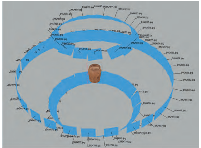
La figura muestra el esquema de fotografías tomadas para construir el modelo 3D: un total de 73 fotos desde diferentes puntos de vista.
